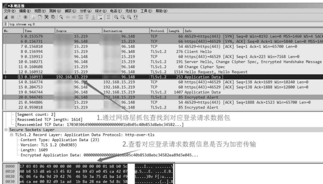
图4-16 在Wireshark工具捕获流中找到对应HTTPS测试网站并查看数据是否加密
