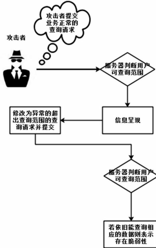
图10-26 测试流程图
