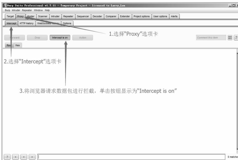
图4-5 将Burp Suite工具中Proxy模块数据包拦截功能开启
