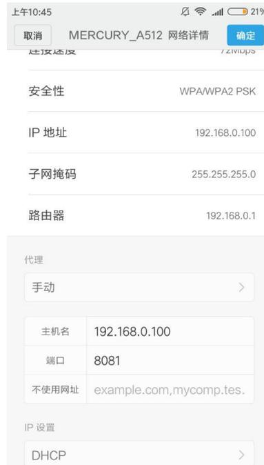
准备完成后打开手机客户端，在代理工具上替换服务器发送给客户端的证书，对客户端和服务器的通信进行 SSL 中间人攻击，成功捕获到客户端和服务器的通信，但通信字段明显经过加密算法处理：
